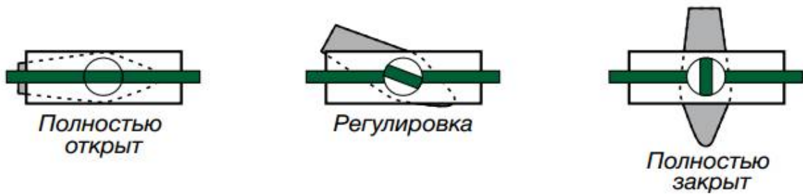
Рис. 2 Принцип действия пробкового крана
