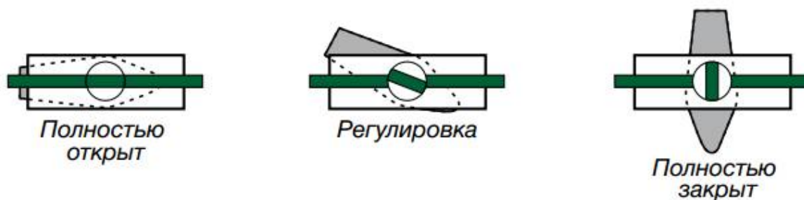
Рис. 2 Принцип действия пробкового крана
