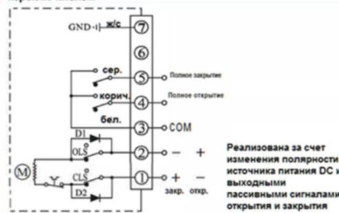
Тип G: Управление постоянным током с пассивным контактным переключателем
