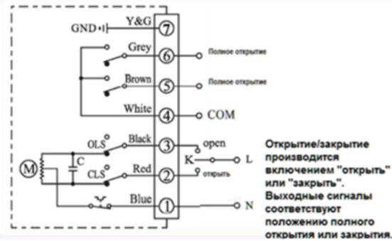
Тип D: Переключатель с потенциометром и пассивным контактом
