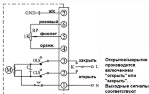
Тип С: Потенциометр 1KΩ (или 500Ω)
