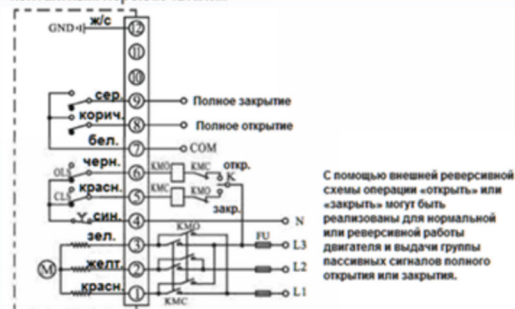
Тип Н: Управление 3-фазным переменным током с пассивным контактным переключателем
