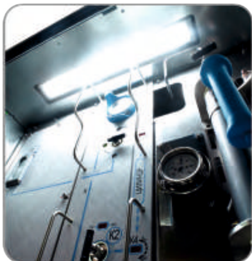
ВЗРЫВОЗАЩИЩЁННЫЙ СВЕТИЛЬНИК ДЛЯ УДОБСТВА РАБОТЫ ОПЕРАТОРА СПО В СУМЕРКАХ И ТЁМНОЕ ВРЕМЯ СУТОК
