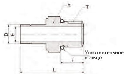
Присоединение фитинга DK-LOK дюймового размера для к цилиндрической резьбе SAE
