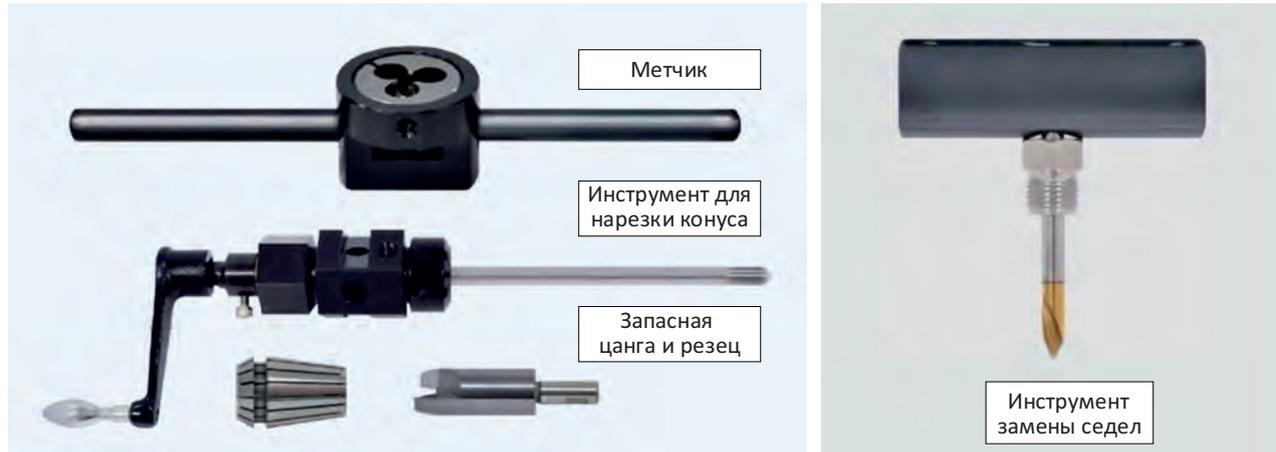
Инструменты для нарезки конуса и резьбы предназначены для простой и точной подготовки концов трубопроводов для подключения на давления 1378 бар (20 000 фунт/кв. дюйм), 4136 бар (60 000 фунт/кв. дюйм) и сверхвысокие давления. Запасные части инструментов взаимозаменяемы, их легко установить и работать с конусообразными концами труб (они не нужны для установок седла).
