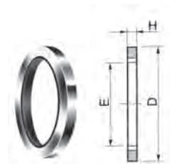
Металлическое уплотнительное кольцо обеспечивает герметизацию между обратным скосом фитинга и ответной частью с внутренней резьбой.
