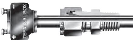
Штуцеры с наружной резьбой DK-LOK со сквозным каналом предназначены для применения с термопарами. Большинство штуцеров с наружной резьбой могут поставляться в виде фитингов со сквозным каналом, кроме штуцеров с небольшим размером (1/8 дюйм) наружной резьбы. Для заказа вставьте Т в код заказа (DMC) штуцера с наружной резьбой. Например: DMCT8-8N-S.
