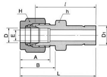
Присоединение трубки дюймовых размеров к фитингу НТА-ПРОМ дюймового размера
