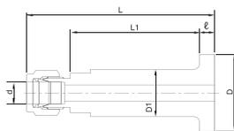
Присоединение фланца к дюймовой трубке
