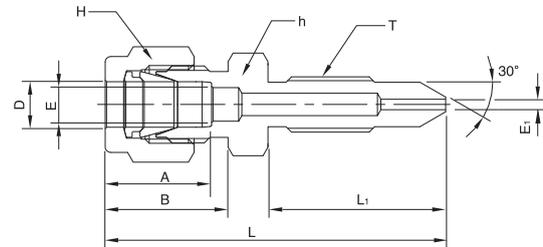
Калибровочный фитинг с резьбой 1U для датчиков перепада давления Honeywell
