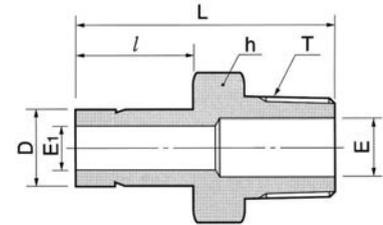
Присоединение фитинга НТА-ПРОМ для труб метрического размера к внутренней резьбе NPT
