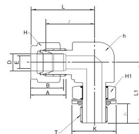
Присоединение трубки дюймовых размеров к цилиндрической резьбе ISO
