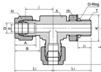
Присоединение трубки дюймового размера к прямой цилиндрической резьбе SAE
