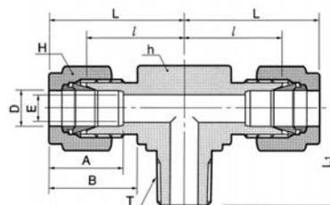
Присоединение трубки дюймовых размеров к внутренней резьбе NPT
