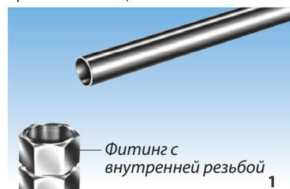
На этом примере при монтаже требуется присоединить трубку к фитингу с внутренней резьбой.
