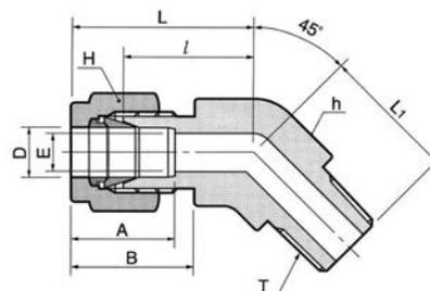
Присоединение трубки дюймовых размеров к внутренней резьбе NPT
