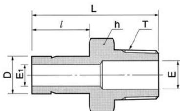
Присоединение обжимного фитинга НТА-ПРОМ для трубок дюймового размера к внутренней резьбе NPT
