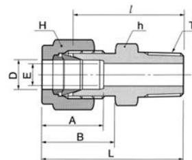
Присоединение метрических трубок к внутренней конической резьбе ISO
