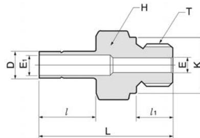
*Присоединение фитинга НТА-ПРОМ дюймового размера к внутренней цилиндрической резьбе ISO*
