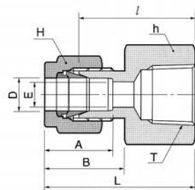
Присоединение метрических трубок к наружной резьбе NPT
