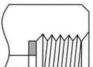
Герметизация с помощью уплотнительного кольца. DIN 3852. Форма Y.
