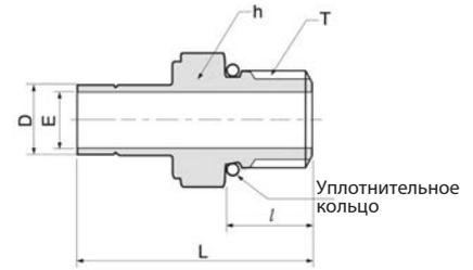
Присоединение фитинга НТА-ПРОМ дюймового размера для к цилиндрической резьбе SAE
