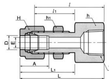
Присоединение трубки дюймовых размеров к наружной резьбе NPT
