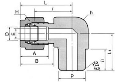
Присоединение трубки дюймового размера к патрубку
