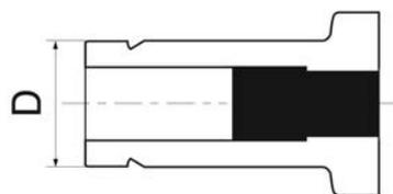
Плавкие предохранители НТА-ПРОМ применяются там, где нагрев может вызвать пожар или взрывоопасную химическую реакцию. Металлический сплав плавкого предохранителя расплавляется или деформируется при определенной температуре. Предохранители рассчитаны на применение с фитингами НТА-ПРОМ с наружным диаметром 3/8 дюйма.
