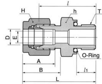
Присоединение дюймовой трубки к внутренней конической резьбе NPT
