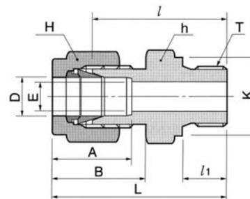
Присоединение трубки дюймовых размеров к внутренней цилиндрической резьбе ISO
