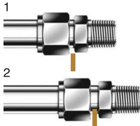
**При первоначальном монтаже щуп для измерения зазоров позволяет убедиться, что гайка фитинга затянута в достаточной степени.**
