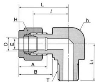
Присоединение трубки дюймовых размеров к внутренней конической резьбе ISO
