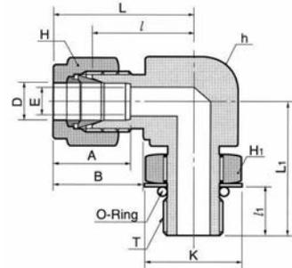
Присоединение трубки дюймового размера к прямой цилиндрической резьбе SAE
