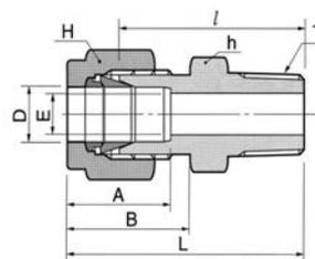
Присоединение метрической трубки к внутренней резьбе NPT
