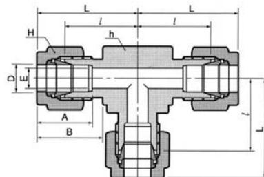
Присоединение трубки дюймовых размеров
