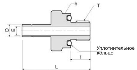
Присоединение фитинга НТА-ПРОМ дюймового размера для к цилиндрической резьбе SAE
