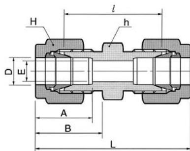
Присоединение трубки дюймовых размеров
