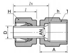
Присоединение корпуса обжимного фитинга НТА-ПРОМ к соединению с наружной резьбой стандарта AN
