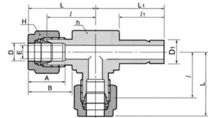
Присоединение метрической трубки к метрическому фитингу НТА-ПРОМ
