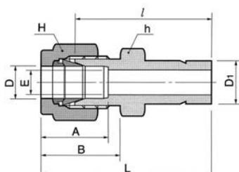
Присоединение метрической трубки к обжимному фитингу НТА-ПРОМ
