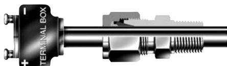
Штуцеры с наружной резьбой НТА-ПРОМ со сквозным каналом предназначены для применения с термопарами. Большинство штуцеров с наружной резьбой могут поставляться в виде фитингов со сквозным каналом, кроме штуцеров с небольшим размером (1/8 дюйм) наружной резьбы. Для заказа вставьте Т в код заказа (FNMC) штуцера с наружной резьбой. Например: FNMCT8-8N-S.
