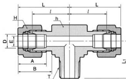
Присоединение метрических трубок к внутренней конической резьбе ISO
