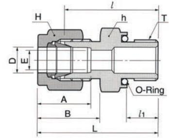
Присоединение дюймовой трубки к прямой внутренней цилиндрической резьбе
