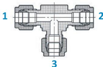
В кодах заказа для тройника в начала указывается размер центрального отвода (1 и 2), а затем размер бокового отвода (3).
