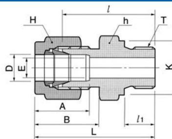
Присоединение трубки дюймовых размеров к внутренней цилиндрической резьбе ISO
