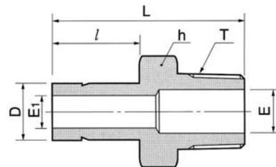
Присоединение фитинга НТА-ПРОМ дюймового размера для к внутренней конической резьбе ISO
