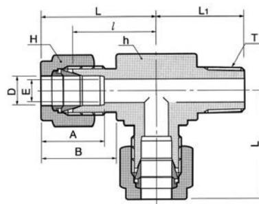
Присоединение трубки дюймовых размеров к внутренней резьбе NPT
