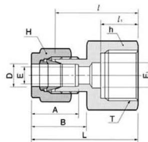
Присоединение трубки дюймовых размеров к метрической резьбе
