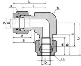
Присоединение трубки дюймовых размеров
