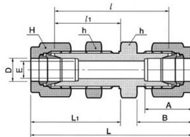
Присоединение трубки дюймовых размеров
