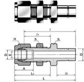
Присоединение трубки дюймового размера к обжимному фитингу НТА-ПРОМ для трубок дюймового размера
