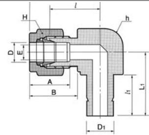
Присоединение метрической трубки к метрическому фитингу НТА-ПРОМ
