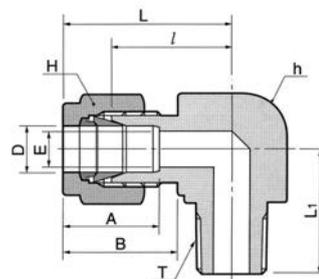
Присоединение трубки дюймовых размеров к внутренней резьбе NPT
