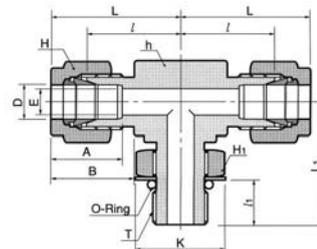
Присоединение трубки дюймового размера к прямой цилиндрической резьбе SAE
