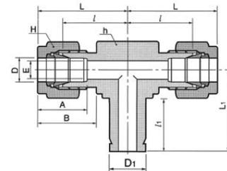
Присоединение метрической трубки к метрическому фитингу НТА-ПРОМ
