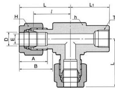
Присоединение трубки дюймовых размеров к наружной резьбе NPT
