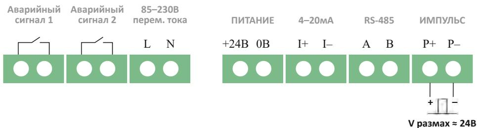
4. Подключения выхода аварийного сигнала
