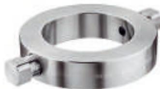
устанавливается между технологическим фланцем и разделительной диафрагмой. Промывочное кольцо предназначено для предотвращения образования твердых отложений под мембраной и, таким образом, предотвращения засорения.
